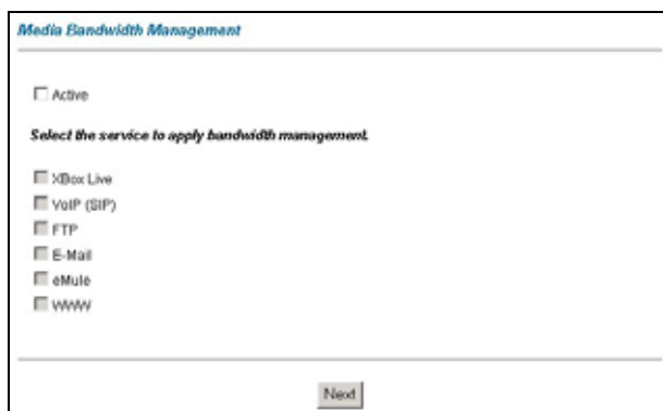
Рис. 14 Управление пропускной способностью канала: Мастер установки, Окно1
